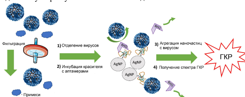
Рис. 1. Схема сенсора для определения вируса гриппа А с префильтрацией.
